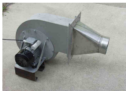
Ventilátor átmeneti idom a füstcső bekötéshez
